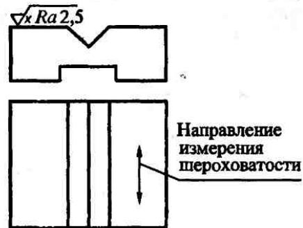
Рис. 7. Указание направления измерения шероховатости
