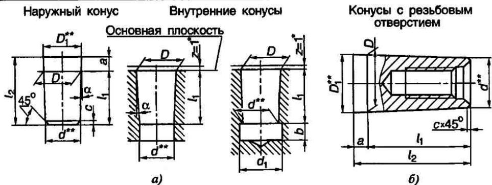
\*z – наибольшее допустимое отклонение положения основной плоскости, в которой находится диаметр  $D$ , от ее теоретического положения.
