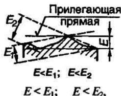
$E, E_1, E_2$  – отклонения наиболее удаленной точки реального профиля от касательной прямой
