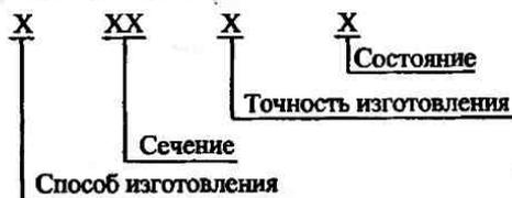
при следующих сокращениях: горячедеформированный (прессованный и горячекатаный) – Г; холоднодеформированный (тянутый) – Д; круглый – КР; шестигранный – ШГ; нормальной точности – Н; повышенной точности – П; полутвердый – П; твердый – Т; вместо отсутствующего показателя ставится знак "X".
