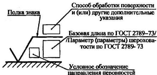
Рис. 2. Структура обозначения шероховатости поверхности
