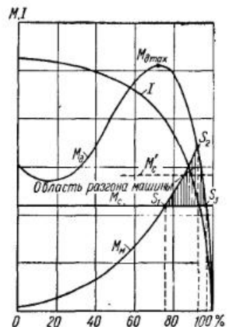
Рис. VIII.4. Характер изменения параметров электродвигателя и муфты в зависимости от угловой скорости ротора
