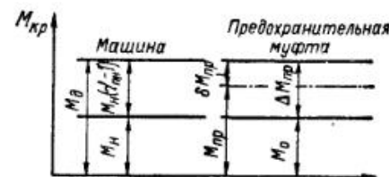
Рис. VII.1. Поле срабатывания предохранительной муфты
